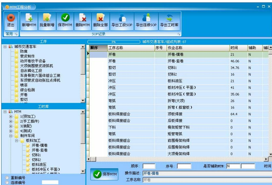
获得的工程分析效果一：整个产品生产体系的连续工时分解；
