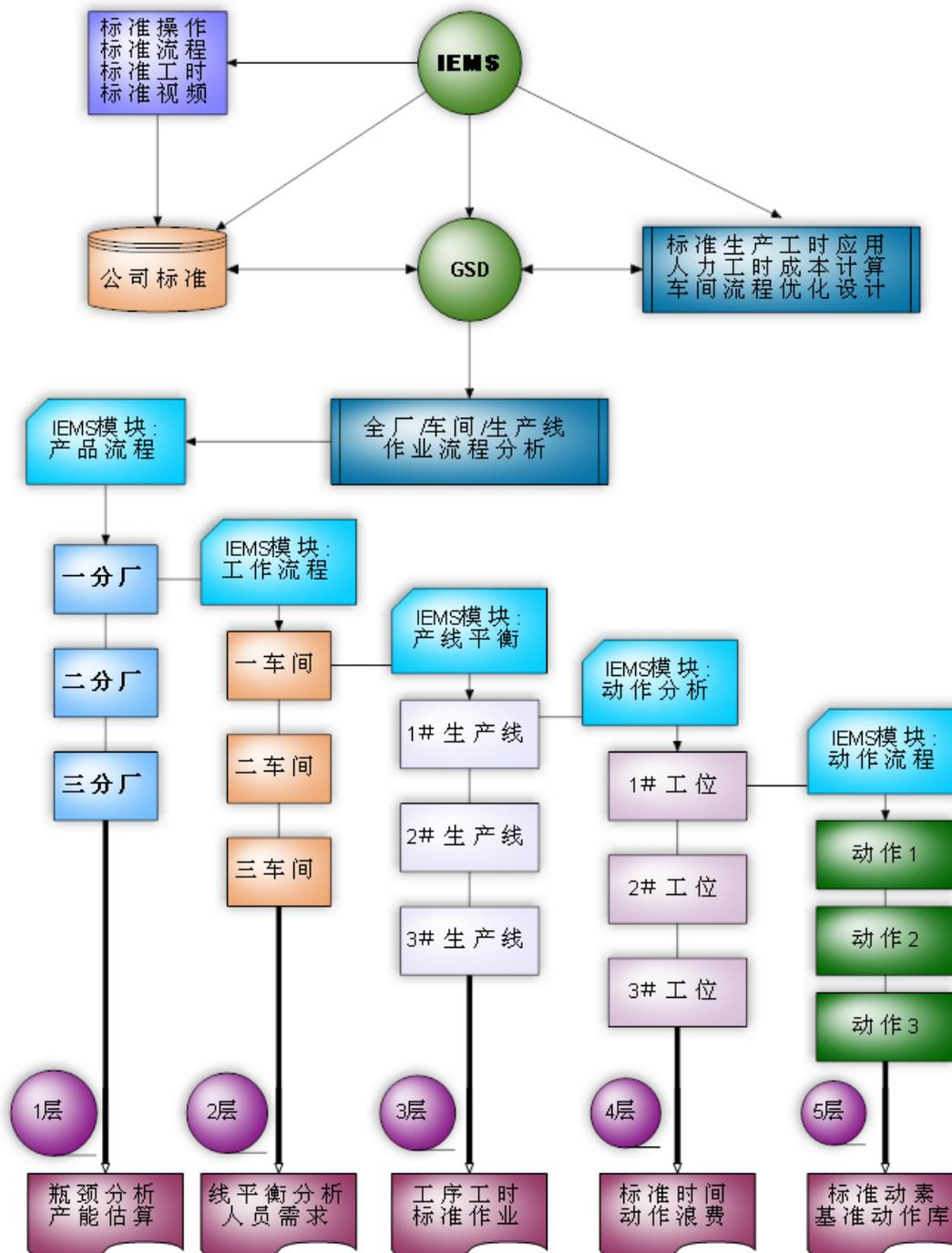
从上图清晰地显示了 IEMS 系统，可以从企业全局一直分析到某条生产线某个工位的某个动作是否合理，几乎涵盖了流程分析在企业的全部应用范围。
