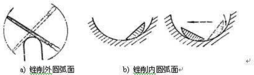
图 9—20 圆弧面锉削方法（滚锉法）
