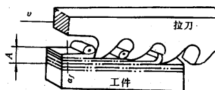
图 8-54 拉削加工原理
