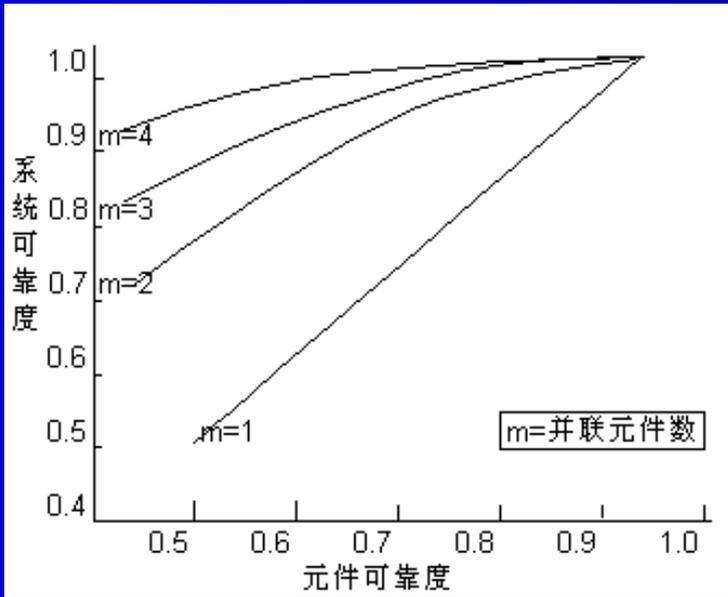
对并联系统，虽然各零件的可靠度不算太高，随着零件个数的增加，系统的可靠度迅速提高。
