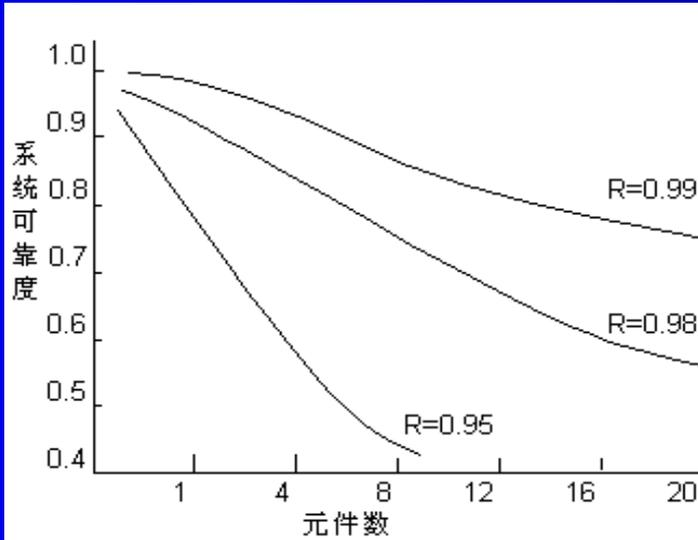
由于元件数目增加而引起系统可靠度的降低在图上表现得很明显。对同样数量的元件，元件可靠度的提高，可使系统的可靠度提高。
