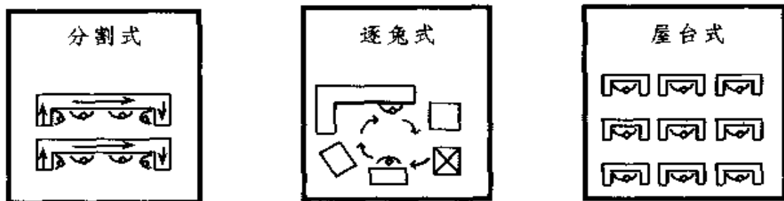
图 4.4 单元生产线的三种类型
