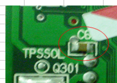
电容与测试点短路不良
