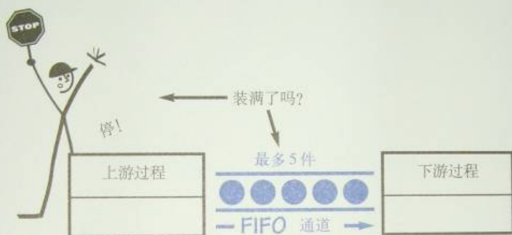
装载 5 个零件的 FIFO 通道示意图
