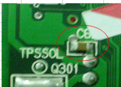
电容与测试点短路不良
