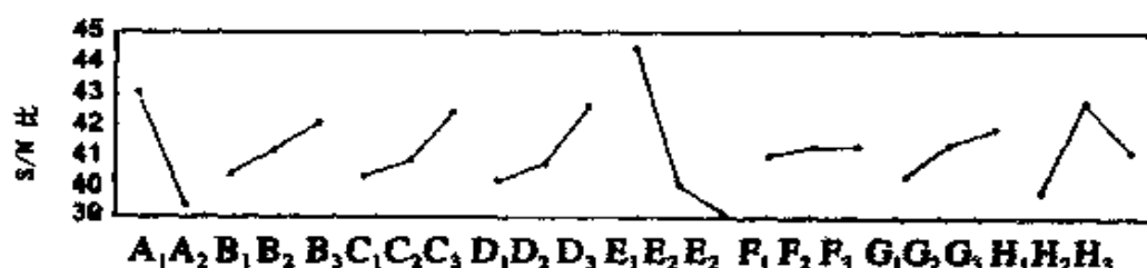
图5-3 瓷砖制程设计实验 S/N 比效应图
