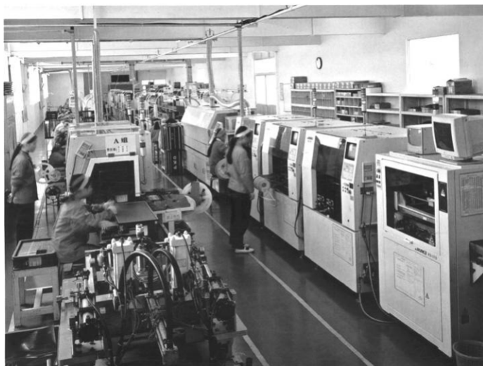
图 8-1 一个流生产之设备布置
