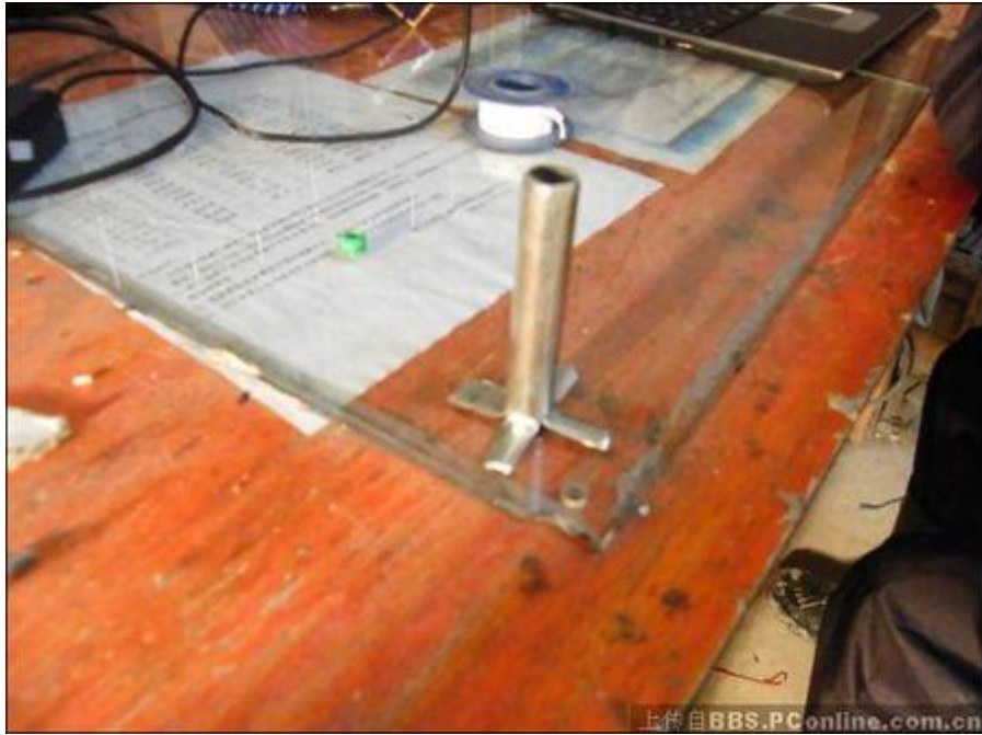
把小铁管用铆钉定在中心位子
