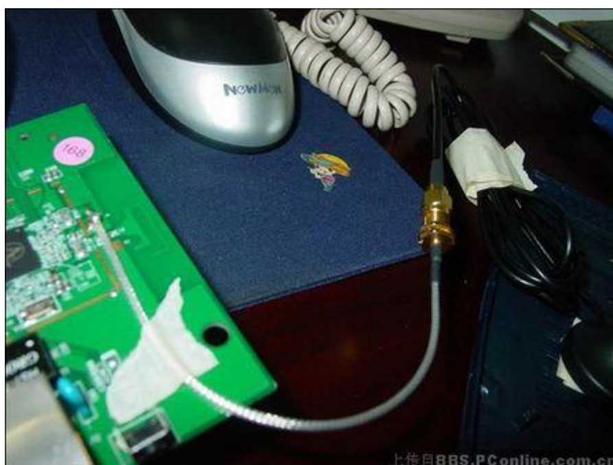
焊接好的效果图,,焊接的时候我非常小心.牢记名剑朋友的提示,焊接一点要饱满.
