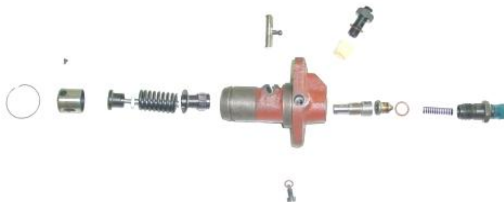
图 2-5 195A 型喷油泵装配原理图
