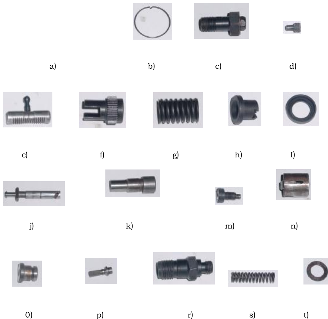
a)泵体 b)卡簧 c)进油嘴 d)导向销 e)调节齿杆 f)调节齿轮 g)柱塞弹簧 h)弹簧下座 I)弹簧上座 j)柱塞 k) 柱塞套 m)定位螺钉 n)推杆体 o)出油阀底座 p)出油阀 r)出油阀紧座 s)出油阀弹簧 t)出油阀垫片
