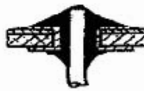
图 A6 铆钉焊点
