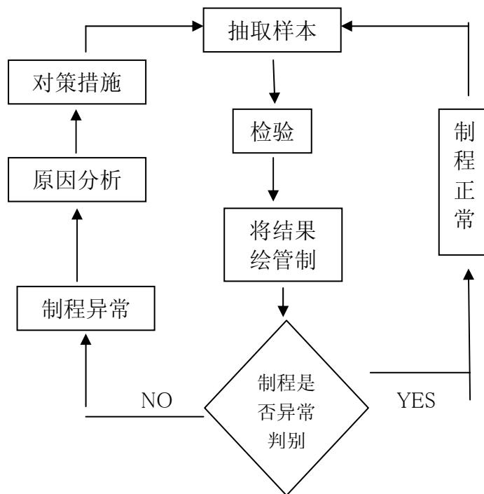
管制图的实施循环
