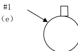
2. 塑料封装三极管的发射极的识别塑料封装的三极管有一个平面，拿着三极管，让平面面对自己，第一号管脚（发射极）就是最左边的管脚，这条管脚必须插在板上点的附近。
