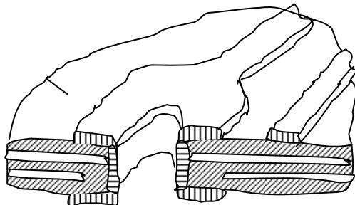
9. **焊盘**——PCB 表面处理加宽局部引线，无绝缘漆覆盖的部分面积，用来连接元件、明线等等。可以包括元件管脚洞。
