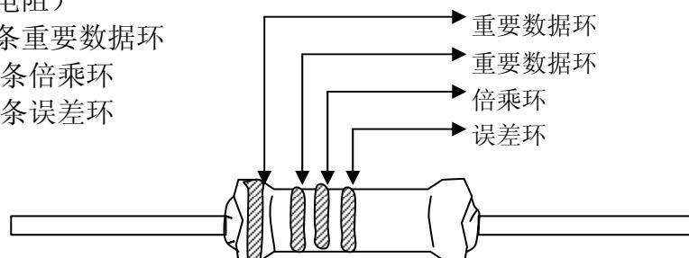
第一道色环印在电阻的金属帽上，表示电阻有效数字的最高位，也表示电阻值色标法读数的方向，第二道色环表示有效数字的次高位，第三道色环表示相乘的倍率，第四环表示误差。金色为±5%，银色为±10%。
