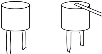
晶体的外形如右图所示, 其外壳用金属封装, 使其外壳坚固, 保护里面的晶片。
