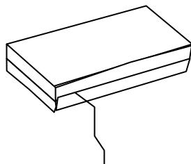
22. 套管——绝缘管套在管脚上，防止管脚靠着其它的元件管脚、金属线或电路。
