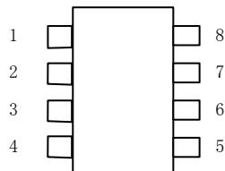
标明第一号管脚的方法可用一小缺口或第一号管脚旁的小白点标明。第一号管脚通常被插入一方盘中，电路板上有一带尖头的方框，IC 插入电路板时，元件体上的缺口应对着尖头。
