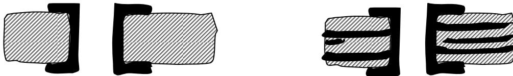
15. **连接孔**——那些一般不用来插元件和布明线的金属化孔。
