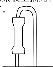
功率在 2W 以上的电阻在插装时不得平贴于电路板上，以防烧坏板上的线路。
