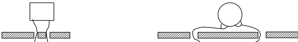
如果电路板上的孔不如元件体宽时，管脚应加套管。如果电路板上的两孔距离过宽时，也应加套管。
