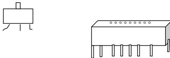
开关的电路符号是: S。开关是有极性的元件, 插入电路板时只能插一个方向。极性标志被在元件体上, 插入时必须与板上极性标志对应。
