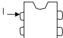
插第一号管脚的孔通常在电路板上用方盘或带尖角的焊盘标明。
