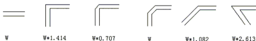
图1-8-13 不同角度走线的拐角线宽变化
