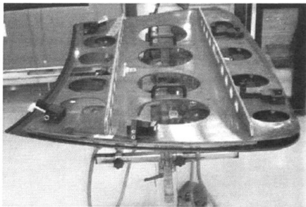
图 5.5 挡风玻璃涂胶模具使用位置 Fig. 5.5 Fixture for windshield gluing using position
