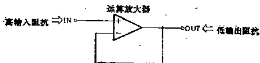
图7-2 由运算放大器组成的缓冲电路
