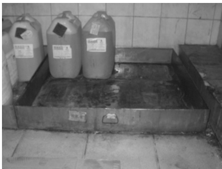
桶裝溶劑放于防泄槽內，避免溶劑泄漏到地面
