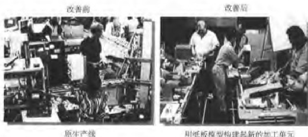
图 7-9 用纸板模型模拟出加工单元
