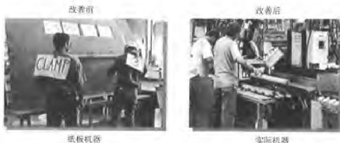
图 7-10 在佩拉机器的实际摆放要经过纸板的模拟
