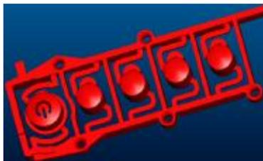
对于只能设计成悬臂梁形式的弹性臂，一般设计成两个弹性臂，以避免按钮在注塑和使用过程中产生歪斜，典型结构如下：
