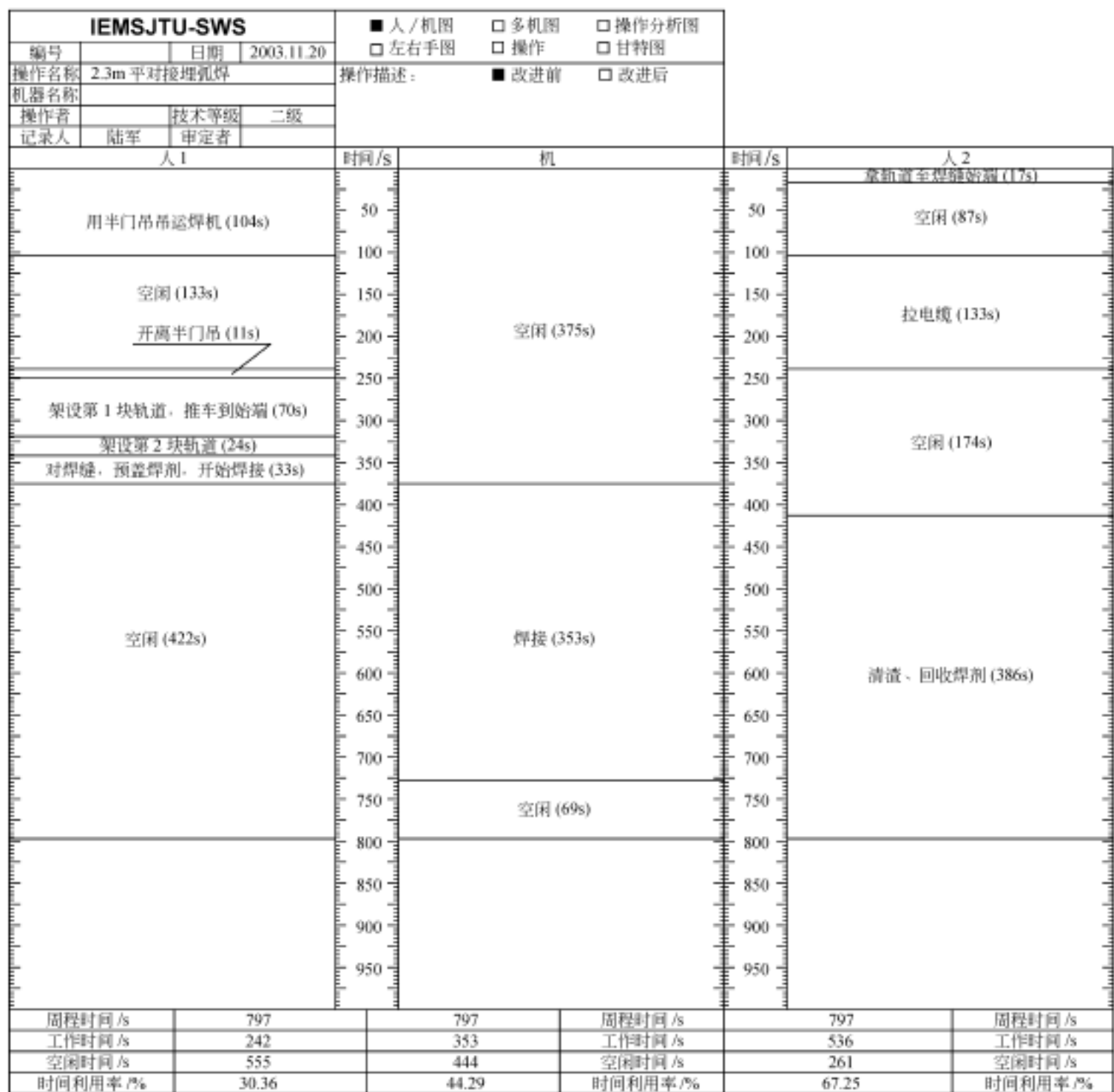
图 10.1 2.3m 平对接缝埋弧焊作业实测人机图
