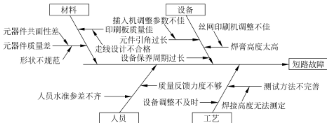
图 14.4 短路故障原因分析的鱼刺图
